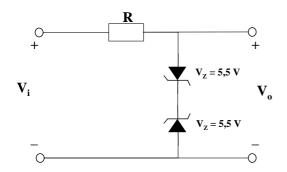
Se utilizan 2 diodos zener idénticos con una tensión zener de 5,5 V.
