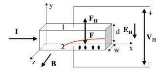
El campo magnético crea una fuerza sobre los portadores de corriente que los empuja hacia la cara 2, generando una densidad de carga diferente en la cara 1 que en la 2 y apareciendo consecuentemente una tensión entre dichas caras que se denomina tensión de Hall. Dicha tensión genera un campo eléctrico que crea una fuerza sobre los portadores de corriente en sentido contrario a la fuerza magnética, cumpliéndose que en el equilibrio las dos fuerzas son iguales:
