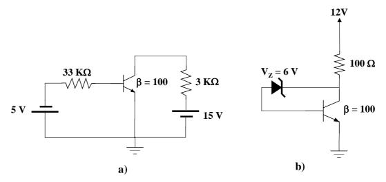
a) Como el transistor es NPN y se está aplicando una tensión negativa entre base y emisor, se está polarizando en inversa la unión de emisor y el transistor estaría en corte =>  $I_C = 0$  y  $V_{CE} = 15$  V
