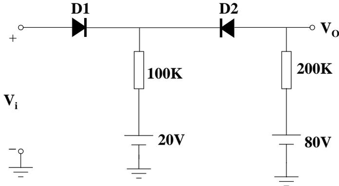
\*  $-\infty < V_i \leq V_x \Rightarrow$  D1 en corte y D2 conduce
