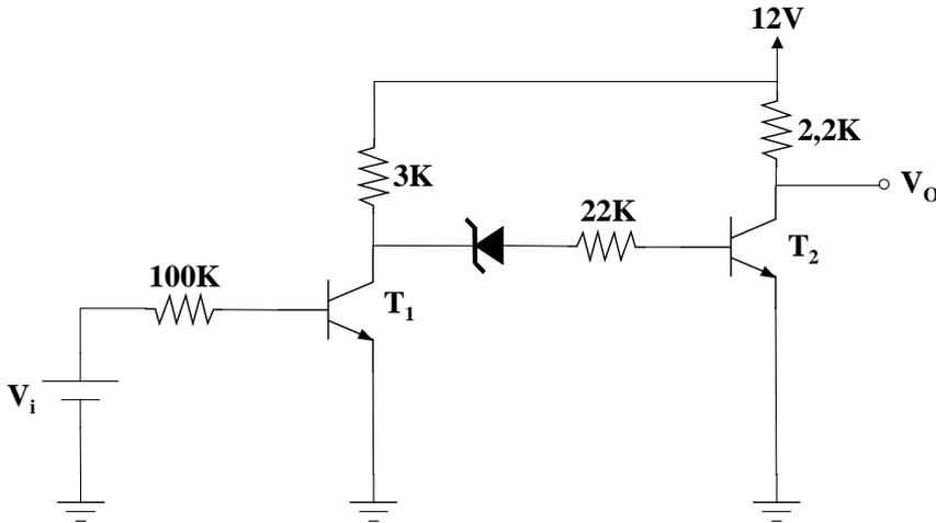
(1) a) Calcular  $V_O$  para  $V_i = 4\text{ V}$ .
