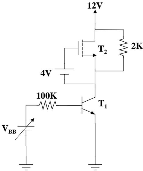
(1,5) a) Calcular el punto de trabajo de los 2 transistores ( $I_C$ ,  $V_{CE}$ ,  $I_D$ ,  $V_{DS}$ ) cuando  $V_{BB} = 10V$ . La característica del MOSFET se puede aproximar por tramos lineales.
