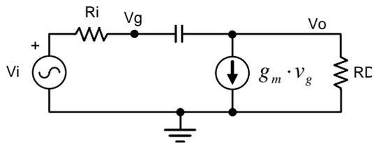
**Figura 4.** Circuito equivalente de pequeña señal para frecuencias altas.
