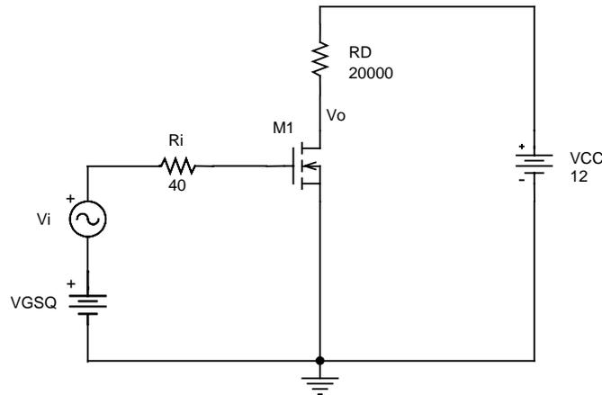
**Figura 1.** Circuito amplificador en fuente común.
