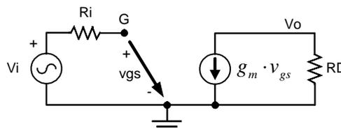
**Figura 2.** Circuito equivalente de pequeña señal para frecuencias medias.
