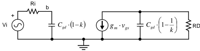
**Figura 3.** Circuito equivalente de pequeña señal para frecuencias altas aplicando Miller.
