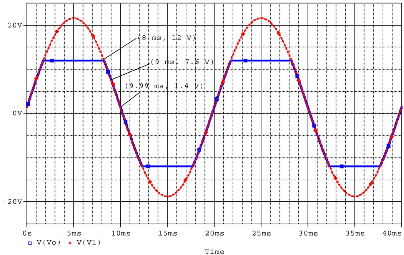
**Figura 1.** Forma de onda esperada (V1) y de la tensión de salida real (Vo), que tiene en cuenta la saturación de la salida del operacional.
