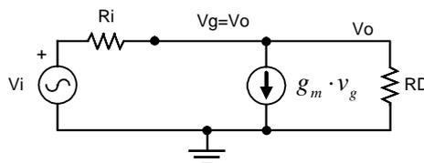
**Figura 5.** Circuito equivalente de pequeña señal muy altas frecuencias.
